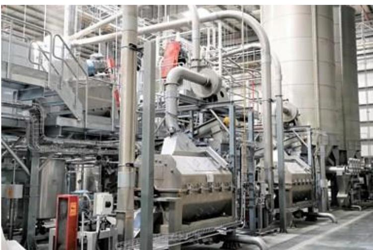
La planta de Envases Universales incluye secciones de alimentación automática, prelavado, desetiquetado, molienda en húmedo, lavado en caliente, flotación, enjuague y secado.
